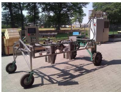
Figura 5. Proyecto ECHORD++: a) Prototipo de cosechadora automática de espárragos verdes [8]; y diagrama conceptual para la recogida de pepinos en el experimento CATCH [9].
