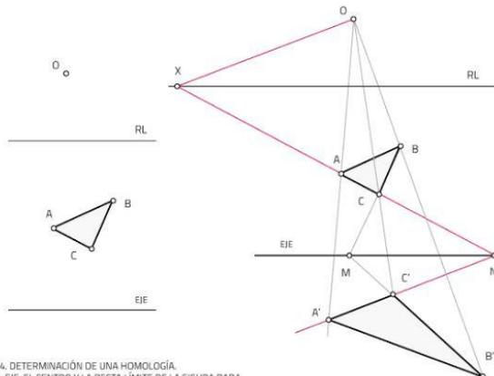
FIGURA 4. DETERMINACIÓN DE UNA HOMOLOGÍA, DADO EL EJE, EL CENTRO Y LA RECTA LÍMITE DE LA FIGURA DADA
