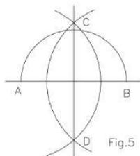
**Método 2****Perpendicular a una recta por un punto exterior**
