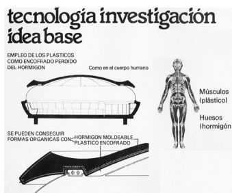
Fig. 3. Sección constructiva del módulo MO.ES y su comparación con la Anatomía Humana. Archivo personal Carmen Beta-Frigola.
