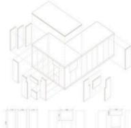
Se plantea la creación de módulos industrializables formados por piezas prefabricadas de CLT (tablero de madera contralaminada).
