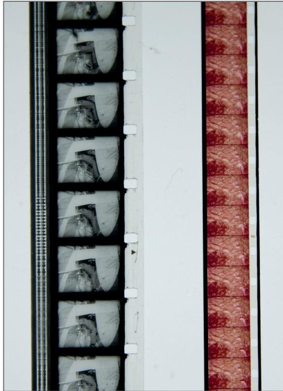
Debido al sistema de proyección, con necesidades diferentes para el movimiento de imagen (intermitente) y sonido (continuo), la sincronización entre ambos requiere de un decalaje en el soporte físico. Esto es la cantidad de fotogramas que separan la imagen de su sonido correspondiente. El cabezal de lectura de sonido se sitúa por delante de la lente de proyección, y el número de fotogramas estandarizado de esta distancia es el siguiente:
