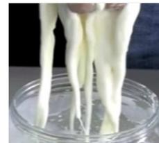
Con presión, las moléculas de este fluido se juntan y se comporta como un sólido (al ser golpeadas por el altavoz), y sin ella, se separan y se comporta como un líquido (al ir por el aire). Los diferentes rebotes de este fluido sobre el altavoz forman curiosas figuras como las que se muestran a continuación.
