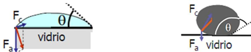
Fig.6 a) El agua moja el vidrio ( $F_a > F_c$ ,  $\theta < 90^\circ$ ) b) El mercurio no moja el vidrio ( $F_a < F_c$ )  $\theta > 90^\circ$
