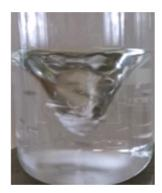
La superficie del líquido adquiere la forma de un paraboloide y la parte central se hunde más a medida que aumenta la velocidad de giro debido al campo gravitatorio y a la fuerza centrífuga.
