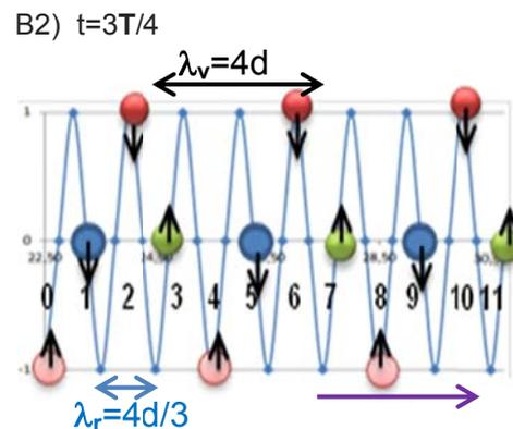
Los péndulos ocupan las mismas posiciones en B1) y B2), tienen la misma onda “visual” de longitud de onda  $4d$ , pero se invierten los movimientos. Las bolas que suben o bajan en B1, bajan o suben en B2.
