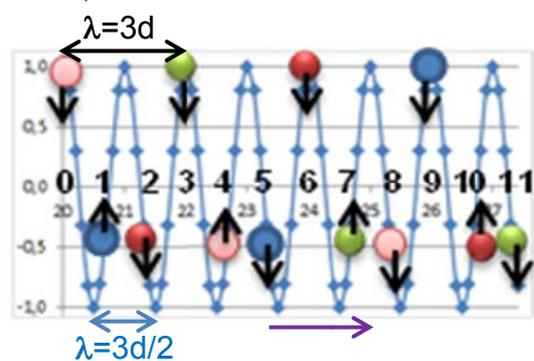
Los péndulos ocupan las mismas posiciones en C1) y C2), tienen la misma onda “visual” de longitud de onda  $3d$ , pero se invierten los movimientos. Las bolas que suben o bajan en C1, bajan o suben en C2.
