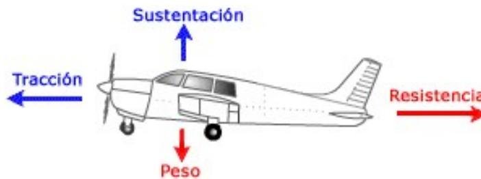
**Peso.** Es la fuerza de atracción gravitatoria sobre un cuerpo y se ejerce sobre el **centro de gravedad CG**. Este CG depende de cómo vaya colocada la carga. Si se colgara un avión por el CG con una cadena el avión estaría en equilibrio.
