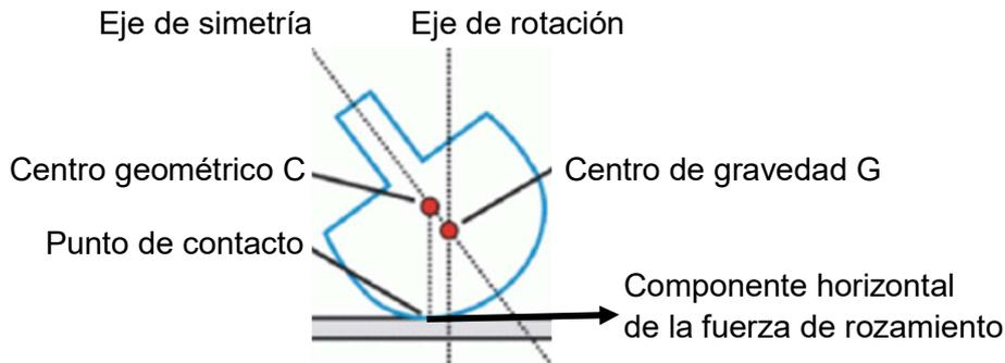
Al invertirse la peonza, G se eleva  $d+2h$ , siendo  $d$ , lo que sobresale la barrita de la esfera, y  $h$ , la distancia entre el centro de la esfera C y el centro de gravedad G. De esta forma, parte de la energía cinética de rotación se emplea en aumentar su energía potencial, produciendo un giro más lento.
