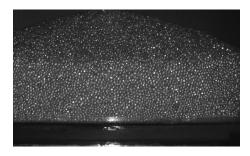
Figura 1.6: Pendientes que se forman al agitar un medio granular verticalmente a una frecuencia mayor de 60 Hz.
