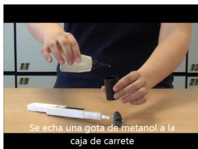
Se coloca una gota de metanol (alcohol de quemar) en la caja del carrete de fotos cuya tapa lleva acoplado un mechero piezoeléctrico. El mechero está preparado para producir una chispa en el envase previamente cerrado. Se frota la caja de carrete para evaporar el metanol. Se enciende el mechero y se produce el “disparo”. La caja de carrete sale volando.
