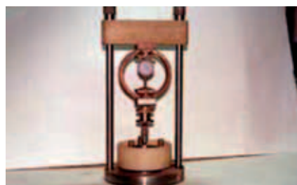
Figura 15. Ensayo Lambe para estudiar el hinchamiento de un suelo.
